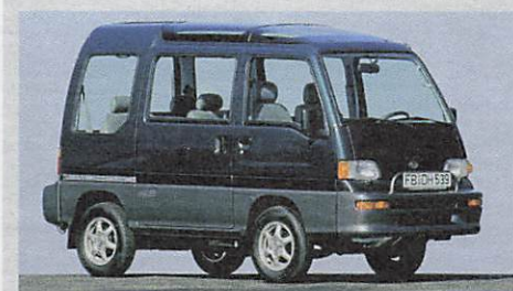
LIBERO SDX Dieser Subaru ist der weltweit kleinste Allrad-Bus mit Platz für sechs Personen. Dreizylinder-Einspritzer, 54 PS, 128 km/h Spitze
