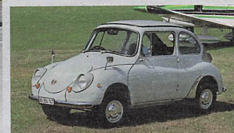
360 Er war 1958 das erste Serienmodell von Subaru mit luftgekühltem Zweizylinder-Zweitakter und 16 PS
