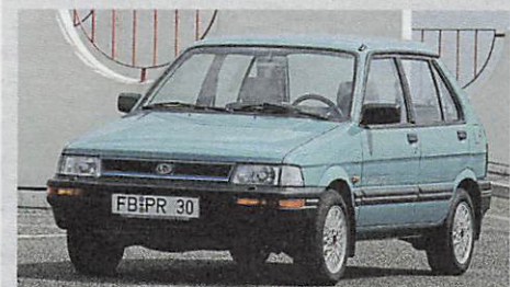
JUSTY Der Justy kam 1984 auf den Markt und war der erste Kleinwagen mit Allradantrieb. Angetrieben wurde er von einem Dreizylinder-Reihenmotor
