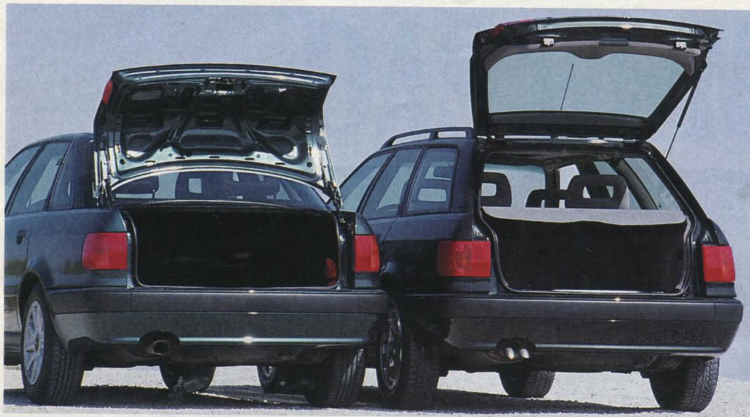
*Das Vergleichsfoto zeigt die Gepäckraumhaube der Limousine und die Heckklappe des Avant. Die Ladekante stimmt überein. Beide Modelle sind 448,2 Zentimeter lang, haben also gleichen Hecküberhang.*
